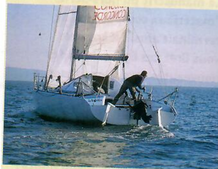
Un grément de monotype récupéré à pas cher : il ne faut pas oublier les bas- taques et supporter les inconvénients du passage à travers le pont.
